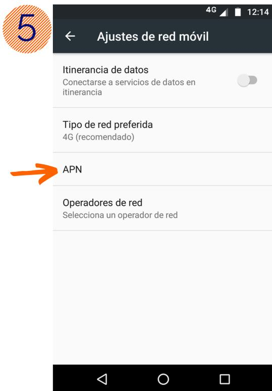
Dentro de Ajustes de red móvil, seleccionar **APN** o **Nombres de puntos de acceso**
